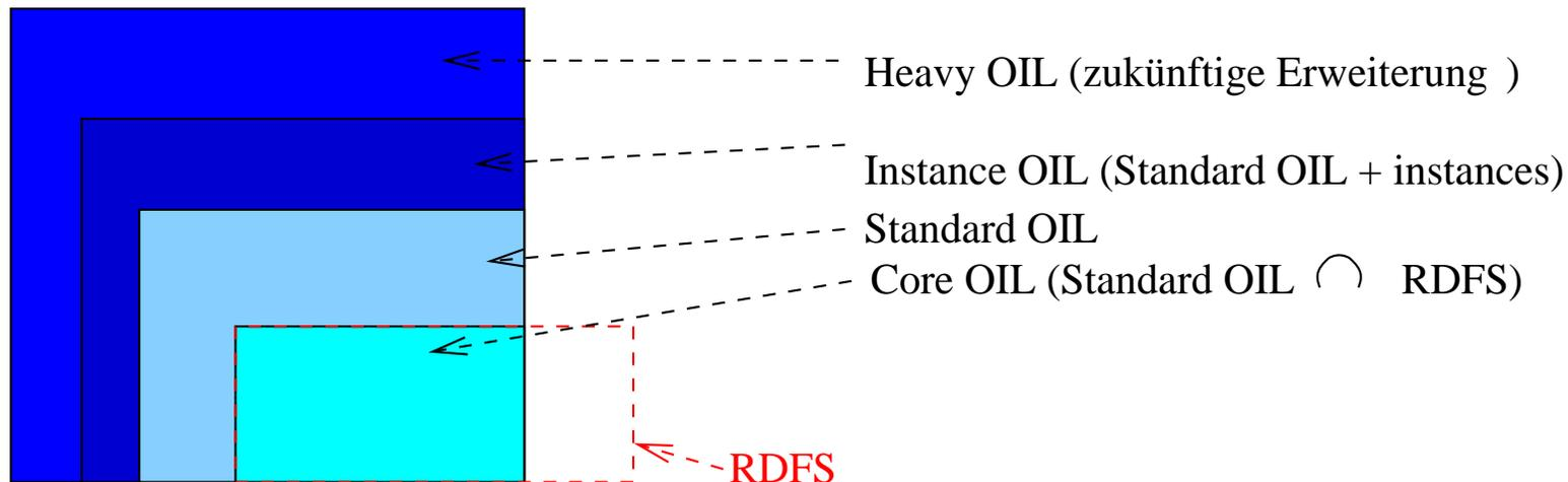
Schichtenarchitektur, abwärtskompatibel: Automaten, die untere Schichten verstehen, verstehen auch Teile aus den oberen Schichten.
